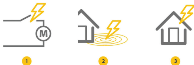
Rys. 4. Źródła przepięć stanowiących zagrożenie dla instalacji sprzętów w budynku Smart Home: 1) przepięcia łączeniowe; 2) pobliskie wyładowanie piorunowe – przepięcia indukowane w pętłach instalacji; 3) bezpośrednie wyładowanie piorunowe w obiekt – zagrożenia związane z wnikaniem części prądu piorunowego do instalacji wewnątrzowych (przepięcia, oddziaływanie cieplne, oddziaływanie mechaniczne).
