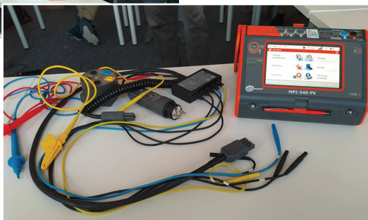
Zestaw miernika MPI-540-PV wykorzystywany w części warsztatowej szkolenia.
